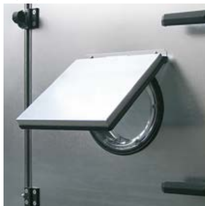
Suojaluukulla varustettu tarkistusikkuna
