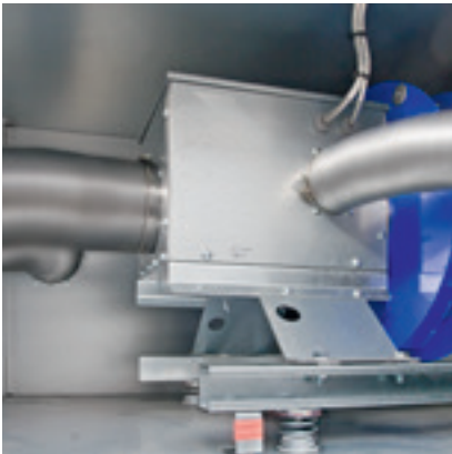
inkapslad motor med extern ventilation
