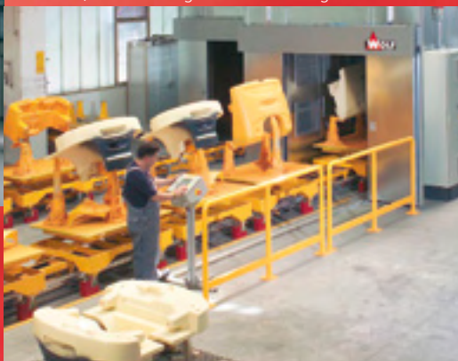
Industrielle Beschichtungsanlage mit Förderstraße und Roboter, Standort Jungheinrich Moosburg
